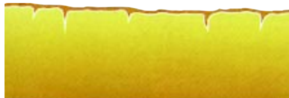
гидротермальная керамика поверхность Si-OH самовосстановление поверхности за счет пластичного гидроксильного слоя
